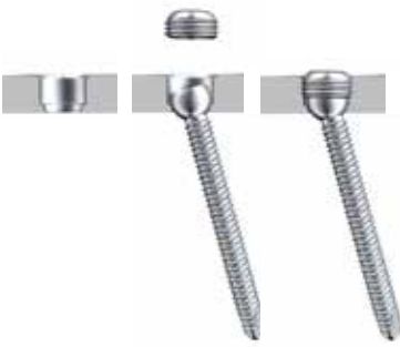
NCBロックングナットにより角度の固定が可能
