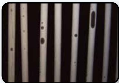
バキュームミキシングシステムを用いて混合し、真空環境下で集積しなかったセメント。マクロポアが高頻度で発生しています。
